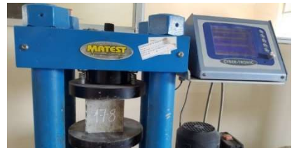
Hình 3.2. Thí nghiệm cường độ chịu nén
