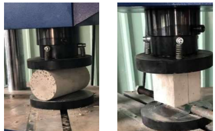
Hình 3.3. Thí nghiệm xác định cường độ chịu kéo khi ép chế
