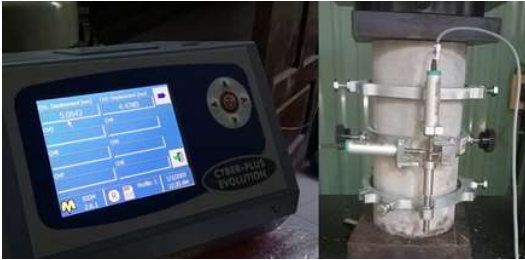
Hình 3.4. Thí nghiệm xác định module đàn hồi và hệ số Poisson
