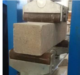
Hình 3.5. Thí nghiệm cường độ kéo khi uốn với sơ đồ uốn 4 điểm
