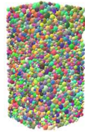
Hình 5.5. Mẫu thí nghiệm số hình hộp chữ nhật được đề xuất
