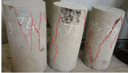
Hình. 5.6. Quan sát vết nứt trên mẫu thí nghiệm số và mẫu thí nghiệm thực nghiệm
