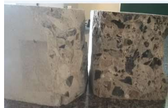
Hình 3.17. Vết nứt của dầm bê tông xi thép trong sơ đồ uốn 4 điểm
